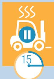
Überhitzung ist Gefahrenquelle Nummer 1 für Reifen. Nach Beanspruchung muss auch Zeit für die Abkühlung sein. Als Faustregel gilt: Ist der Stapler zwei Kilometer gefahren, müssen die Reifen zunächst 15 Minuten abkühlen, bevor es weitergehen kann!
